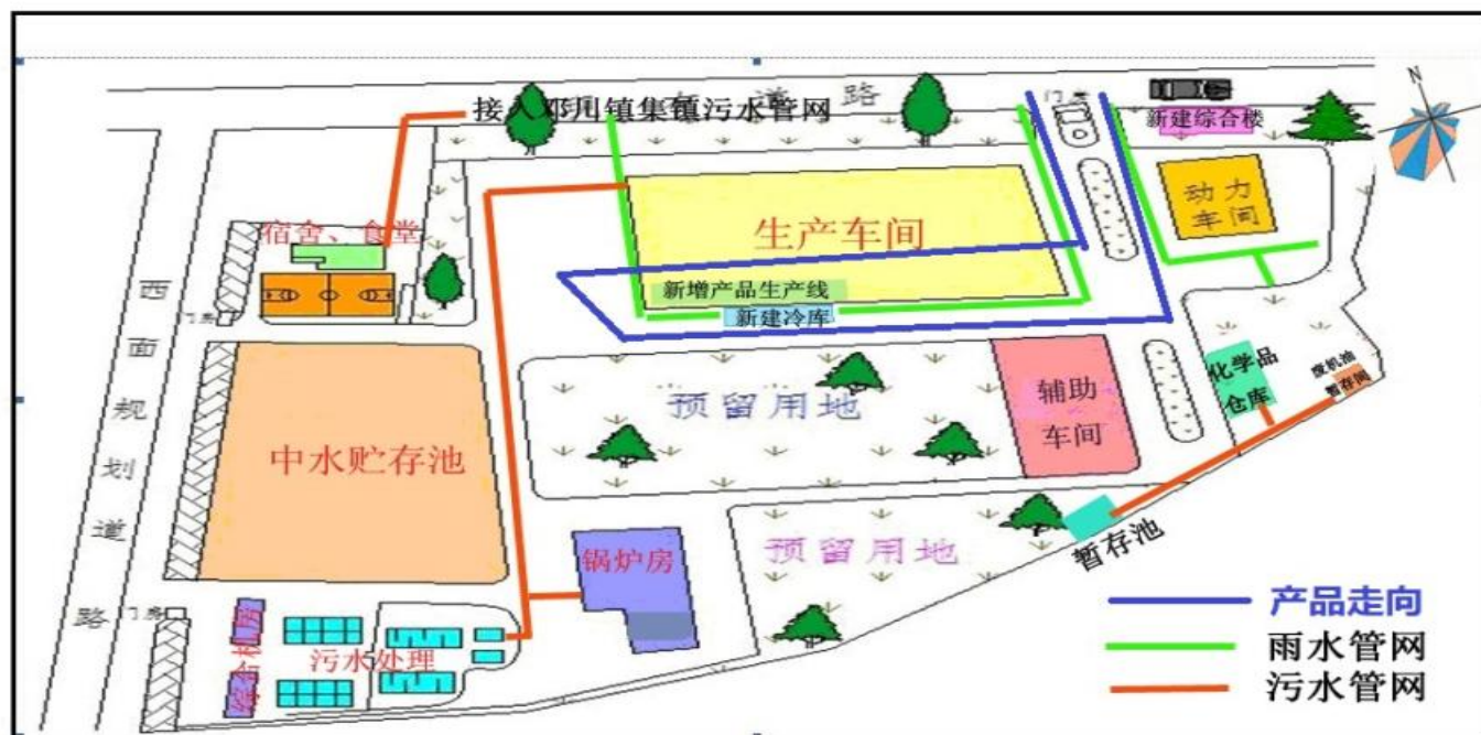
云南新希望邓川蝶泉乳业有限公司新厂雨污管网分布图
